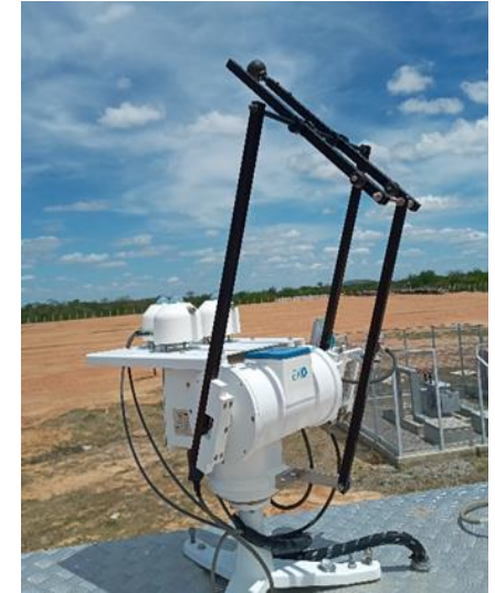
Figura 4: Rastreador solar com piranômetros classe A do CRESP.
