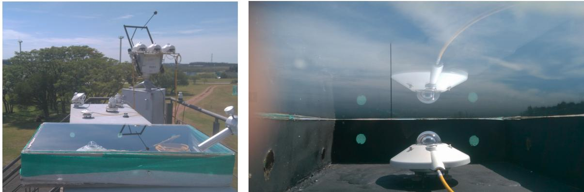
Figura 1: Izq. Seguidor solar SOLIS2 con dos pirheliómetros, uno de ellos ajustado con una muestra del vidrio para medida de transmitancia directa normal y caja con vidrio para medida de transmitancia global sobre plano horizontal. Der. Interior de la caja con piranómetro y cobertura vidriada.
