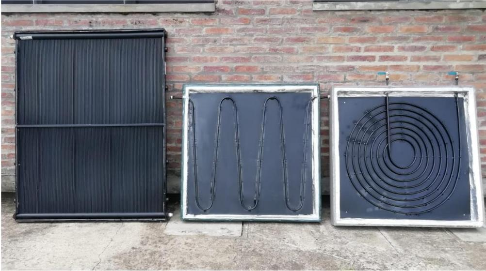
Figura 1- Fotografía de la placa colectora de los tres colectores FPC1, FPC2 y FPC3- de izquierda a derecha.
