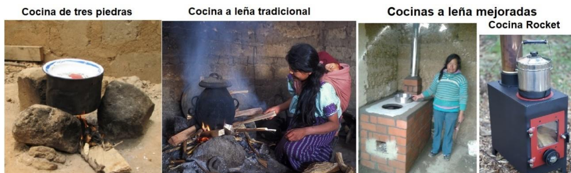
Figura 1. Evolución de artefactos de cocción a leña: a la izquierda, cocina tradicional de tres piedras; al centro, cocina a leña tradicional; a la derecha, cocinas mejoradas con salida de humos al exterior, incluyendo el modelo tipo Rocket.
