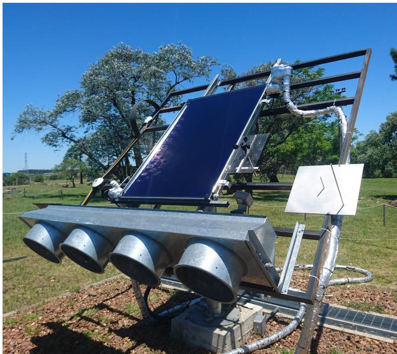
Figura 3.2: Montaje del colector en el seguidor solar.
