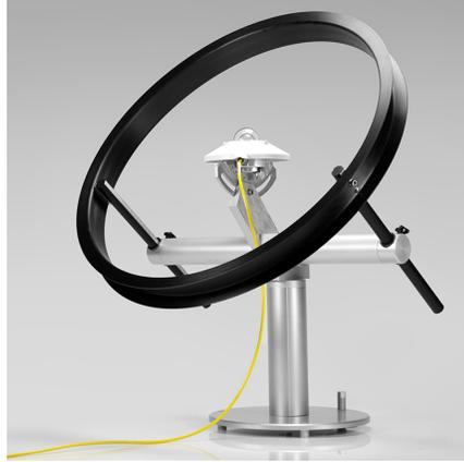
Figura 3.3: Equipo de medición de irradiancia difusa en plano horizontal con banda de sombra. Fuente: Kipp & Zonen.
