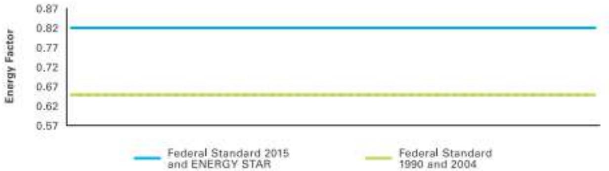
Figura 22. Requisitos de eficiencia para calentadores de agua sin almacenamiento a gas [24].
