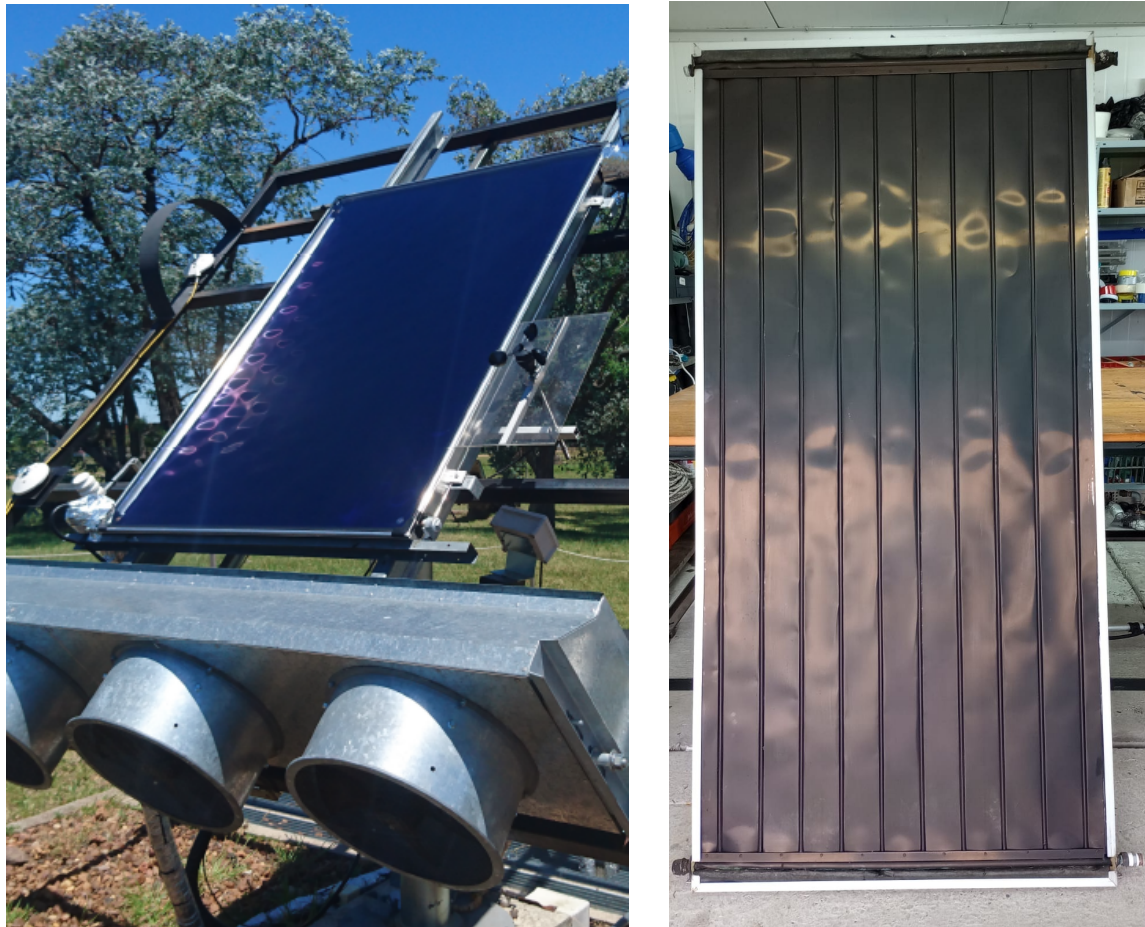
Figura 3.2: Se muestran dos fotografías del colector. A la izquierda se observa el colector montado en el banco de ensayos y a la derecha se muestra el colector en el taller, sin la cubierta de vidrio.
