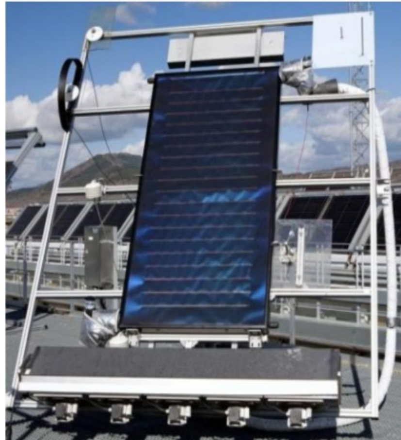
Banco ensayo colectores (CENER) Navarra, España
